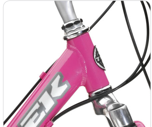
Abb. 1 | Kein Gusset; wenn in der Übersicht links gelistet, ist das Rad vom Rückruf betroffen.
