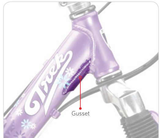
Abb. 2 | Gusset vorhanden. NICHT vom Rückruf betroffen.
