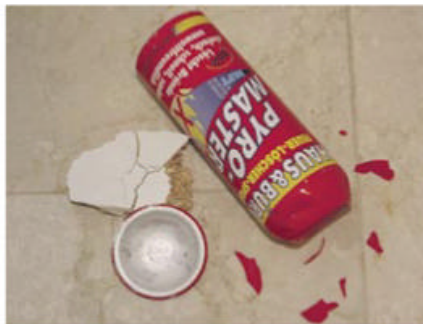
Als Helfer in der Not war der handliche Feuerlöscher Pyro-Master gedacht. Ein Produktionsfehler macht ihn aber zum gefährlichen Sprengsatz, wie diese explodierte Dose zeigt. Foto: Renftel
