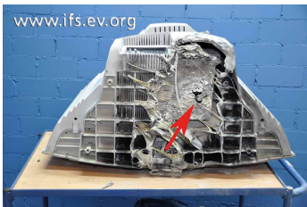
Ein Loewe-Fernsehgerät mit der charakteristischen Durchbrennung an der Unterseite
